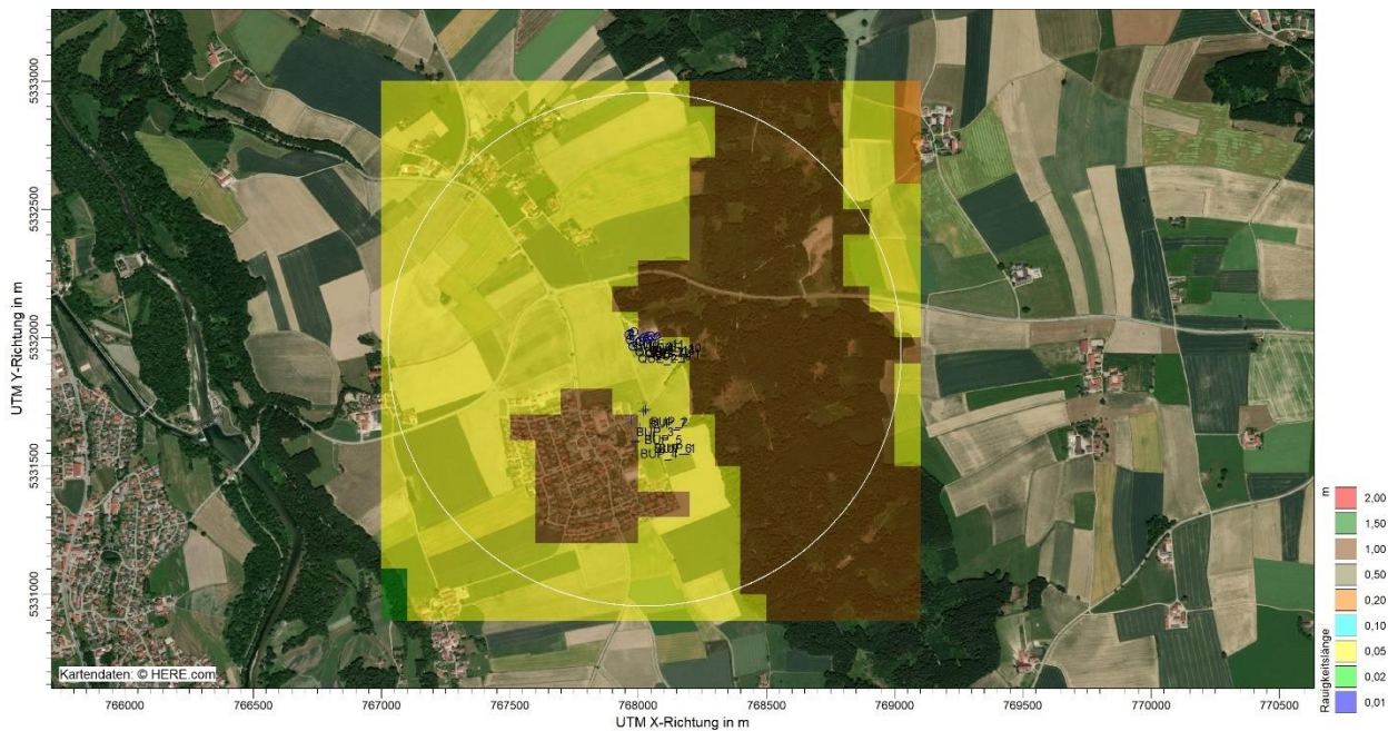
Abbildung 12: Darstellung des Parameters der Oberflächenrauigkeit z_0 im Umfeld der Anlage, Radius 1 km - heterogene Verteilung der z_0 -Werte
