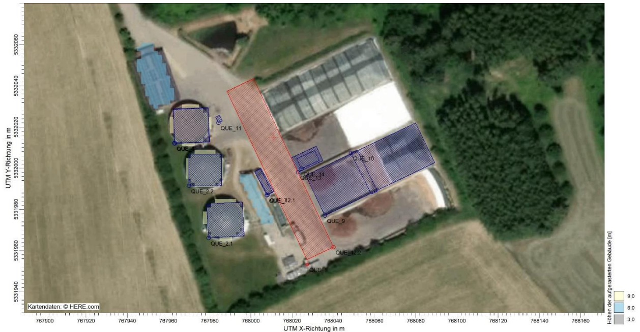
Abbildung 5: Räumliche Lage der Emissionsquellen der Biogasanlage: Punktquelle Kamin des BHKW, Flächenquellen (Ausdehnung in der Ebene, rot schraffiert) und Volumenquellen (blau schraffiert, Ausdehnung in Länge x Breite x Höhe)
